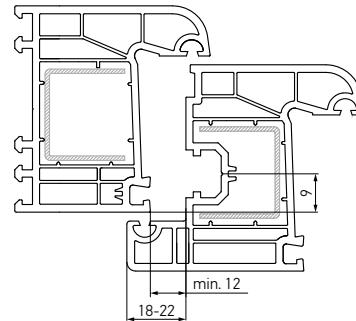
Sash rebate gap (A): min. 12 mm
