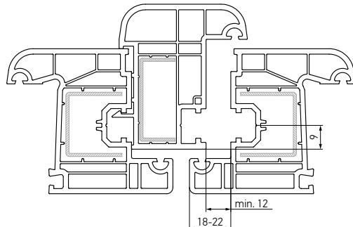
Sash rebate gap (A): min. 12 mm
